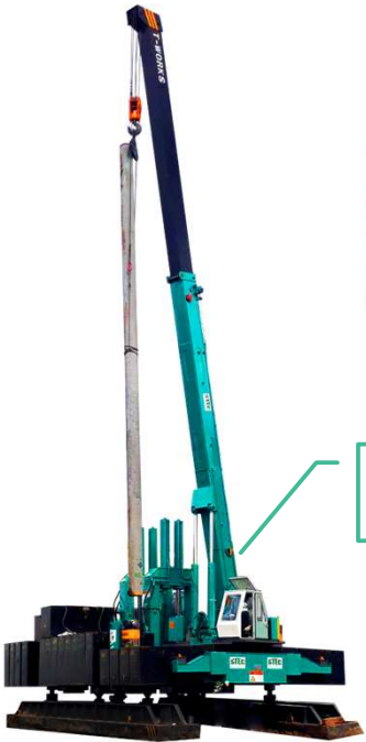
เครื่องกดเสาเข็ม Jack in Pile
