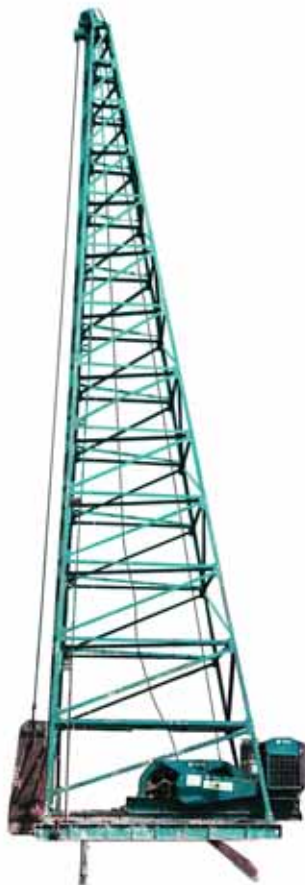
05 ปั่นจั่นโครง ( Conventional Pile Driver )
