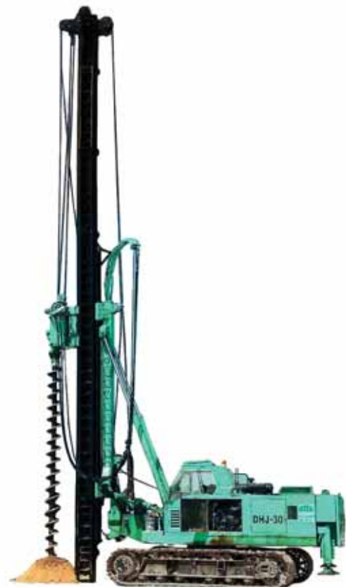
06 เครื่องเจาะ 프리บอร์ ( Pre Bore )
